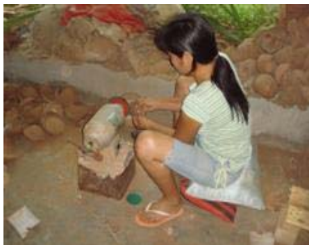
ขั้นตอนที่ 5 ขัดผิวกะลาให้เรียบด้วยเครื่อง
